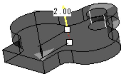
图 4-3 创建拉伸实体
